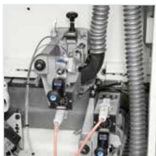
Grupo refilador R-K: cambio automático rápido de trabajo entre canto fino, de espesor y madera maciza.
