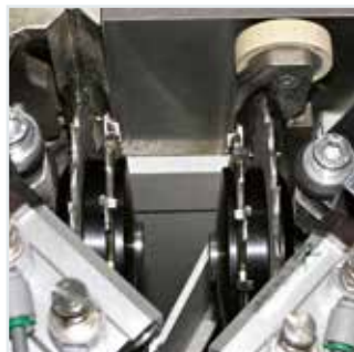
Grupo retestador K-2 Radius: corte y radio en una sola operación.
