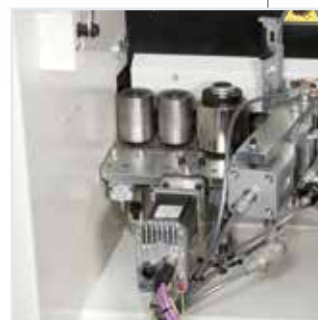
Rodillos de presión con posicionamiento desde eje CN y intervención temporizada
