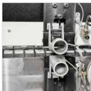
Grupo rasacola RC-N: Elimina los excesos de cola en la unión entre tablero y canto. Trabajo Nesting.
