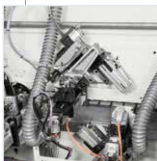
Grupo redondeador ROUND X-MULTIEDGE de 2 motores con ejes CN para el set up automatico.
