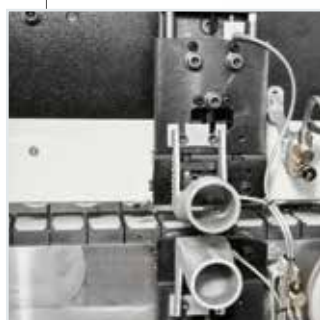
Grupo rascacola RC-N: Elimina los excesos de cola en la unión entre tablero y canto. Trabajo Nesting.
