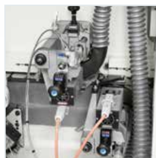
Grupo refilador R-K: cambio rápido de trabajo entre canto fino, de espesor y macizo.
