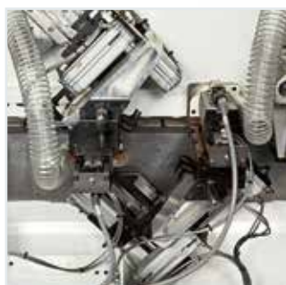
Grupo redondeador ROUND X de 2 motores: Excelente calidad del panel con contemporáneo redondeado y refilado del canto.
