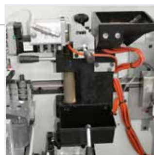
Línea de unión perfecta y uso de cola EVA y PUR gracias al tanque cola "SGP".
