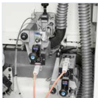
Grupo refillador R-K: cambio rápido de trabajo entre canto fino, de espesor y macizo.
