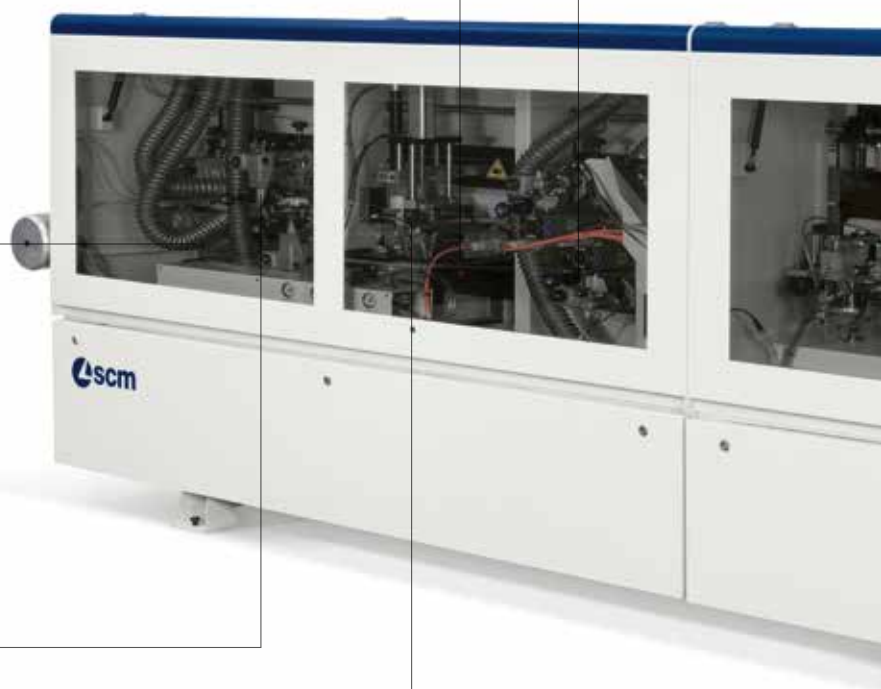
Grupo rascacola RC-N: elimina los excesos de cola en la unión entre tablero y canto. Trabajo Nesting
