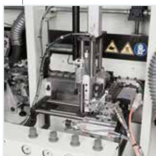
Grupo redondeador ROUND 1: acabado de los ángulos en paneles rectos y perfilados.
