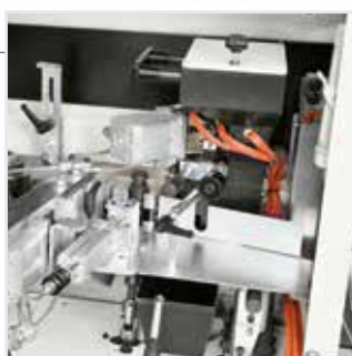
Tanque cola SGP-E: aplicación homogénea de la cola en todos los materiales.
