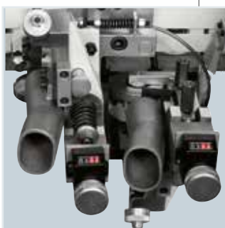
Grupo rascacanto RAS/K: Elimina de los cantos en plástico las marcas dejadas por las herramientas.
