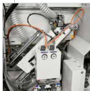
Grupo retestador K/SEL: óptimo acabado gracias a la inclinación automática de las sierras.
