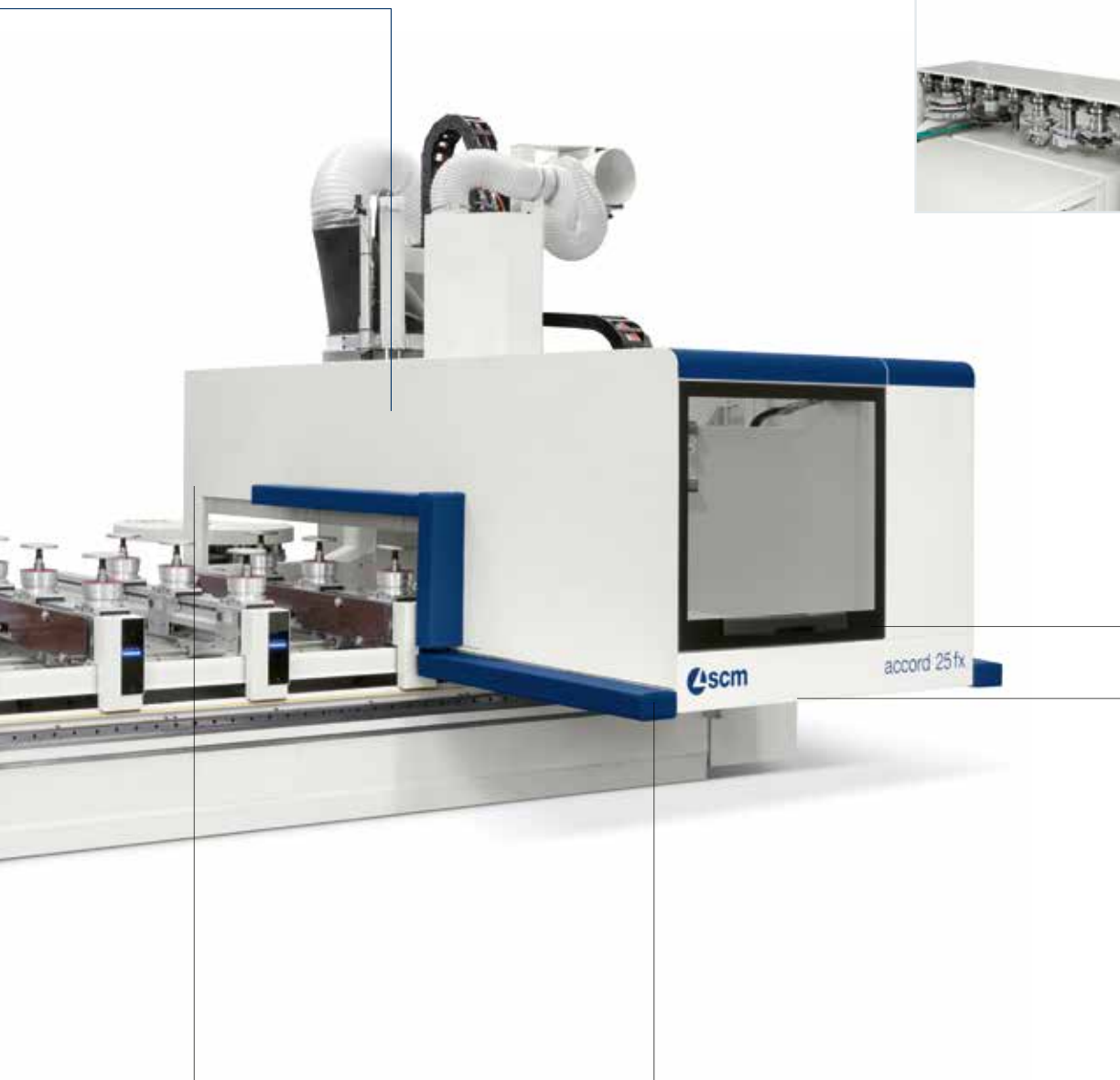
Almacén de cadena con 32 posiciones anclado al puente móvil, desarrollado para gestionar herramientas de elevado peso y gran tamaño.
