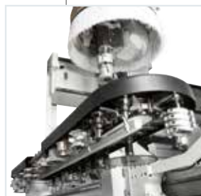
Almacén de cadena con 48 posiciones anclado al puente móvil, desarrollado para gestionar herramientas de elevado peso y gran tamaño.
