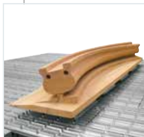
Mesa de trabajo multifuncional adaptable a cualquier necesidad de referencia y sujeción de la pieza.
