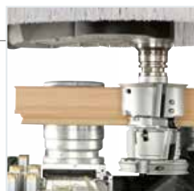
Grupo operador PRISMA con cabezal fresador de 5 ejes.
