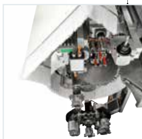
Unidad de trabajo adicional BRC con eje vertical independiente.
