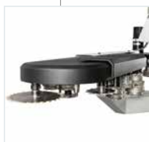
Almacén de cadena con 32 posiciones anclado al puente móvil, desarrollado para gestionar herramientas de elevado peso y gran tamaño.
