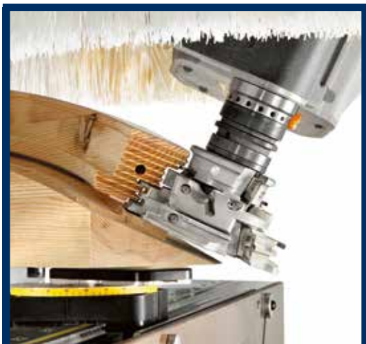
Grupo operador PRISMA con cabezal fresador de 5 ejes.
