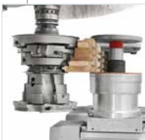
Mesa de trabajo con altura 145 mm (H145) para trabajar con herramientas de doble perfil elementos de diferente espesor.
