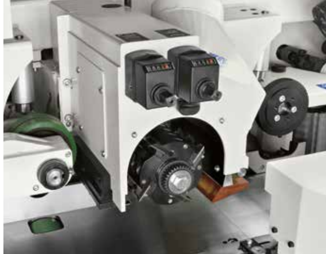
Kit para el perfilado del eje horizontal superior Incluye 2 visualizadores mecánicos con precisión decimal. Diámetro mín./máx. de la herramienta 100/180 mm. Carrera axial 40 mm.
