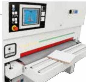
Secuenciador para la introducción del tablero para reducir los costes de gestión de la máquina.
