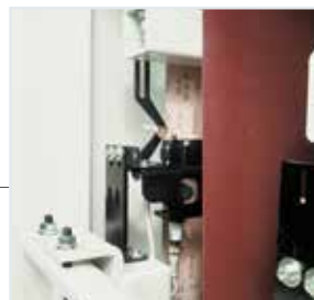
Fotocélula de oscilación de las bandas para una mayor duración de la banda.
