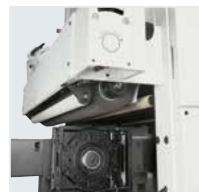
Grupo satinador y grupo estructurador en la salida de la mesa para acabados exclusivos.
