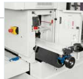
Grupo cepillo intercambiable en la salida de la mesa para una elevada flexibilidad de trabajo.
