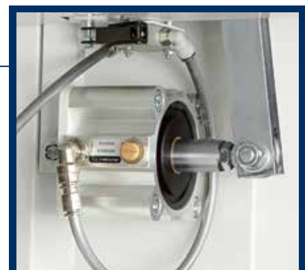
Centrado automático de la cinta para una mayor duración de la banda transportadora.
