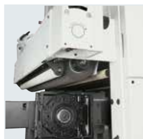
Grupo satinador oscilante y grupo estructurador en salida de la mesa para acabados exclusivos.
