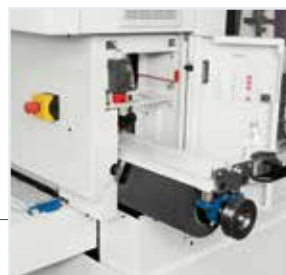
Grupo cepillo intercambiable en salida de la mesa para una elevada flexibilidad de trabajo.
